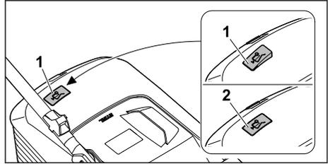
Der vom Messer erzeugte Luftstrom hebt die Füllstandsanzeige (1) an. Ist der Grasfangkorb gefüllt, stoppt der Luftstrom. Ist der Luftstrom zu gering, fällt die Füllstandsanzeige (2) in den Ruhezustand zurück. Dies ist ein Hinweis den Grasfangkorb zu entleeren.
