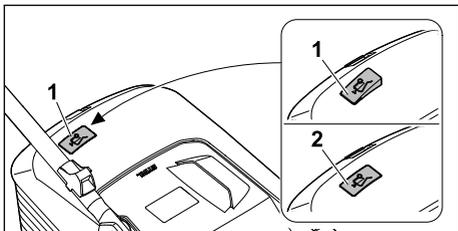
Den luftstrøm, der genereres af kniven, hæver niveaumåleren (1). Når græsopsamlingskurven er fuld, stopper luftstrømmen. Hvis luftstrømmen er for lav, vender niveaumåleren (2) tilbage til tomgangs tilstand. Dette er en indikation på, at græsopsamlingskurven skal tømmes.
