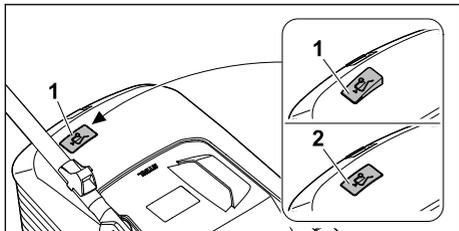
Proud vzduchu, který vzniká rotací řezného nože, zvedá indikátor naplnění (1). S naplněním sběrného koše na trávu proud vzduchu zeslábne. Pokud je proud vzduchu příliš slabý, klesne indikátor naplnění (2) do klidového stavu. To znamená, že je nutné sběrný koš na trávu vyprázdnit.
