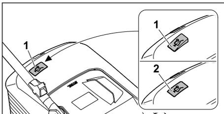
Поток воздуха, создаваемый ножом, поднимает индикатор заполнения травосборника (1). Если травосборник заполнен, поток воздуха останавливается. При недостаточном потоке воздуха индикатор заполнения травосборника (1) не поднимается.
