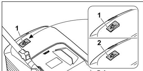
O fluxo de ar gerado pelas lâminas faz elevar o indicador do nível (1). Se a cesta de recolha de relva estiver cheia, o fluxo de ar para. Se o fluxo de ar for diminuto, o indicador do nível (2) volta
