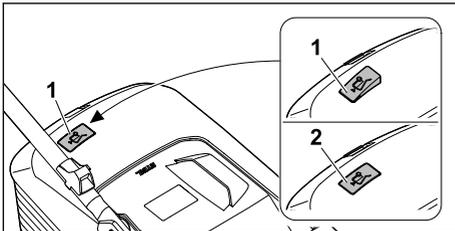
Zračna struja koju proizvodi nož podiže pokazivač razine napunjenosti (1). Kad je košara za travu puna, zračna se struja prekida. Ako je zračna struja preniska, pokazivač razine napunjenosti (2) vraća se u stanje mirovanja. To je znak da treba isprazniti košaru za travu.
