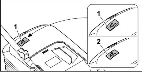
Bıçakla üretilen hava akımı, doluluk seviyesi göstergesinin (1) kalkmasına neden olur. Çim toplama sepeti dolduğunda hava akımı durur. Hava akımı çok azsa doluluk seviyesi göstergesi (2) bekleme durumuna geçer. Bu, çim toplama sepetini boşaltmanız için bir uyarıdır.
