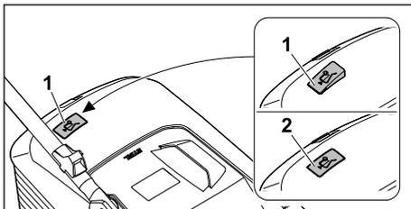
Luftstrømmen fra kniven hever nivåindikatoren (1). Når oppsamleren er full, stanser luftstrømmen. Hvis luftstrømmen er for lav, går nivåindikatoren (2) tilbake til hviletilstand. Det er et tegn på at oppsamleren må tømmes.
