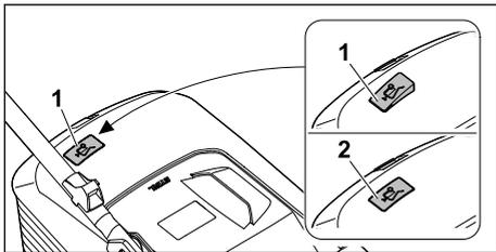
Strumień powietrza wytworzony przez nóż podnosi wskaźnik napelnienia (1). Po napelnieniu się kosza na trawę strumień powietrza ulega zatrzymaniu. Jeżeli strumień powietrza będzie zbyt mały, wskaźnik napelnienia (2) opadnie do położenia spoczynkowego. Wskazuje to na konieczność opróżnienia kosza na trawę.
