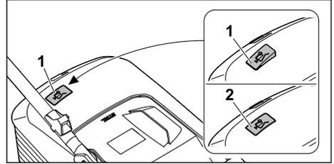
Zračni tok, ki ga ustvari nož, zvišuje prikaz napoljenosti (1). Če je košara za travo napolnjena, se zračni tok ustavi. Če je zračni tok premajhen, se prikaz napoljenosti (2) vrne v stanje mirovanja. To je znak za izpraznitev košare za travo.
