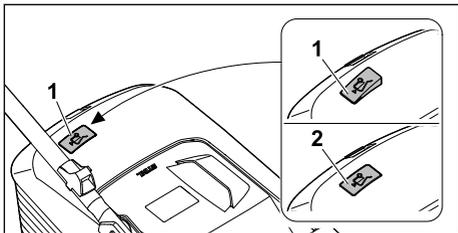
A kés által keltett légáram megemeli a telítettséggeljelzőt (1). Ha a fűgyűjtő kosár megtelt, a légáramlás megszakad. Amikor túlságosan gyenge a légáram, a telítettséggeljelző (2) visszatér az alapállapotába. Ez azt jelzi, hogy ki kell üríteni a fűgyűjtő kosarat.
