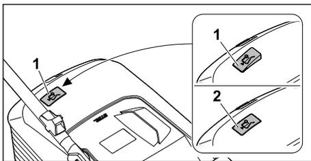
El flujo de aire generado por la cuchilla eleva el indicador de nivel de llenado (1). Si el recogedor de hierba está lleno, el flujo de aire se detiene. Si el flujo de aire es insuficiente, el indicador de nivel de llenado (2) baja otra vez al modo de reposo. Esta es una indicación para vaciar el recogedor de hierba.
