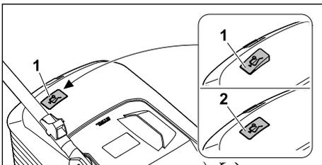
Terän aiheuttama ilmavirta nostaa täyttömäärän osoitinta (1). Kun ruohonkeruusäiliö on täynnä, ilmavirta pysähtyy. Kun ilmavirta on liian pieni, täyttömäärän osoitin (2) laskeutuu alas lepoo- sentoon. Tämä osoittaa, että ruohonkeruusäiliö on tyhjennettävä.
